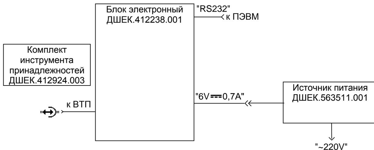
**1.4.2** БЭ предназначен для возбуждения вихревых токов в объекте контроля посредством ручного вихретокового преобразователя, приема отраженных сигналов, обработки и индикации результатов контроля.
